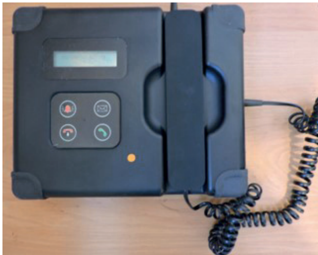
Zdjęcie 3. Urządzenie do komunikacji z centralą monitorowania
