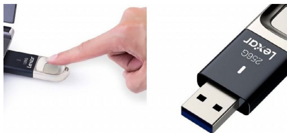
Rysunek 4. Przykład ultramobilnego zastosowania czytnika linii papilarnych w pamięci przenośnej USB
