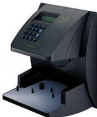
Rysunek 5. Czytnik geometrii dłoni najnowszej generacji Handkey II firmy Recognition Systems Inc.
